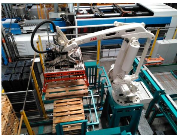
Figura 6.16: Sistema di pallettizzazione contenitori
