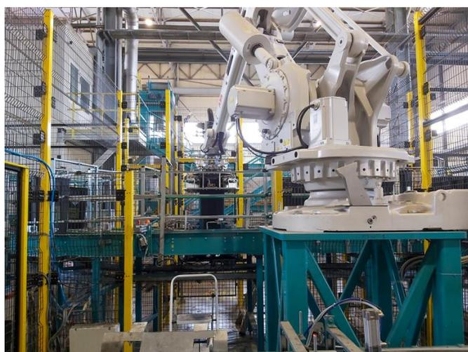
Figura 6.7: Robot per la movimentazione dei contenitori alla tramoggia di carico
