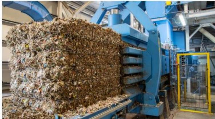
*Figura 6.9: Esempio di pressa orizzontale*
